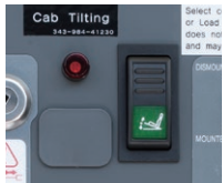
Indicador e interruptor de inclinación de la cabina
