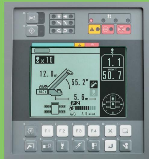
O AML-C da Tadano é fácil de usar. Ele permite que o operador monitore simultaneamente: o ângulo da lança, o comprimento da lança, a pressão de operação do cilindro de elevação, a largura de extensão dos estabilizadores, a posição de giro, a capacidade nominal de içamento e a carga de içamento.
