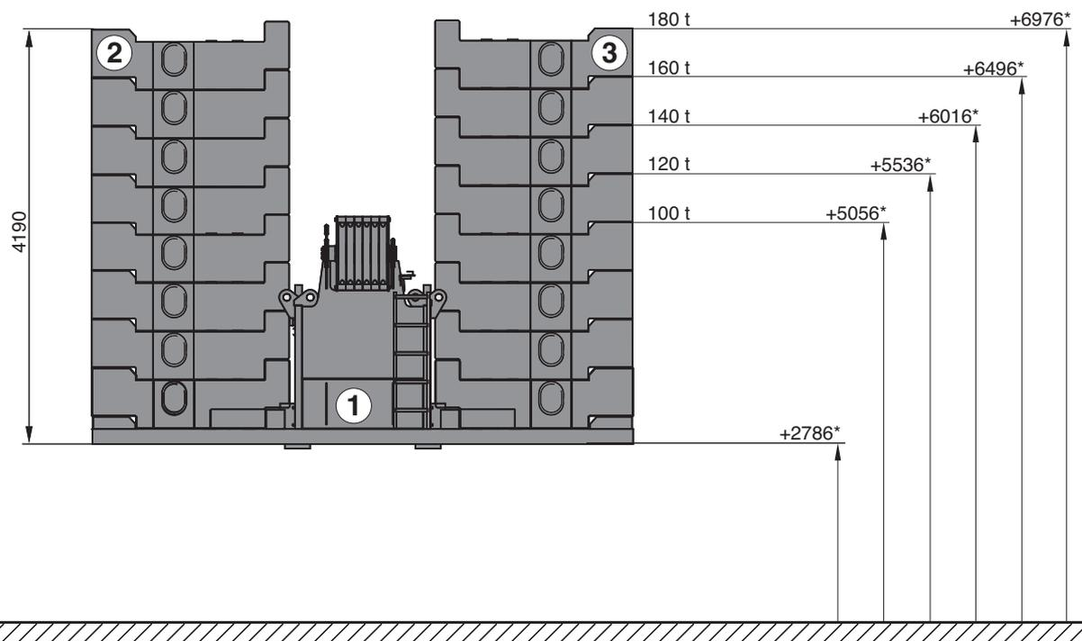
\* Tail swing above ground · Durchschwenkhöhe über Boden · Giration AR au-dessus du sol · Oscillazione posteriore sul livello del suolo · Radio de giro trasero sobre el suelo · Giro da traseira acima do solo · Вынос хвостовой части над поверхностью
