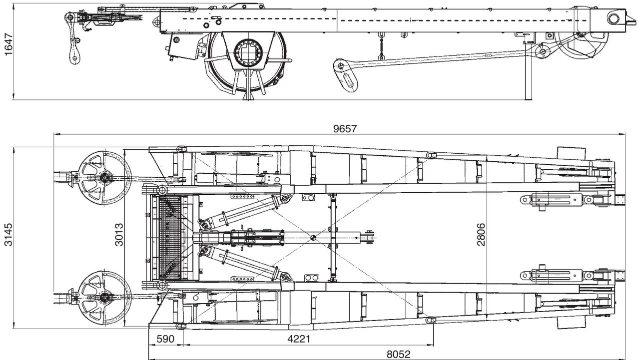
Outriggers · Abstützungen · Calage · Stabilizzatori · Estabilizadores · Estabilizadores ·
