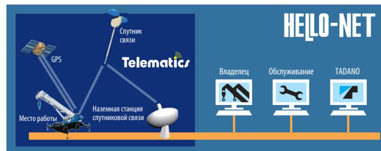
Система Telematics (система регистрации данных и мониторинга машины) с системой HELLO-NET по Интернету (\*доступность зависит от страны). ПОДРОБНЫЕ СВЕДЕНИЯ. Доступность систем передачи данных, например спутниковой или мобильной связи, которые помогают расширить зону обслуживания, зависит от страны. Кроме того, существуют страны, в которых эта система как таковая не используется. Для получения дополнительных сведений обратитесь к дистрибьютору или сотрудникам отдела продаж.
