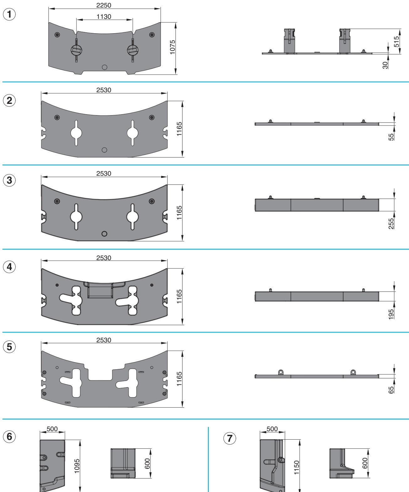
When using H2, counterweight ⑦ is not applicable · Wenn H2 verwendet wird, entfällt Gegengewicht ⑦ ·
